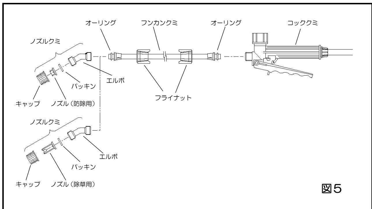
取付ネジ径 G1/4 の市販ノズルをご使用になる場合は、付属のニップルクミをフンカシクミの先に取り付けてご使用ください。
